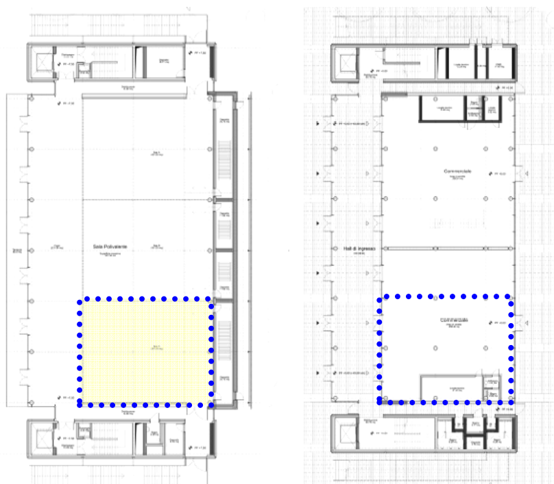
Figura 5.1 - Indicazione della porzione di solaio oggetto di verifica (a sinistra) e della sua proiezione al piano terra
